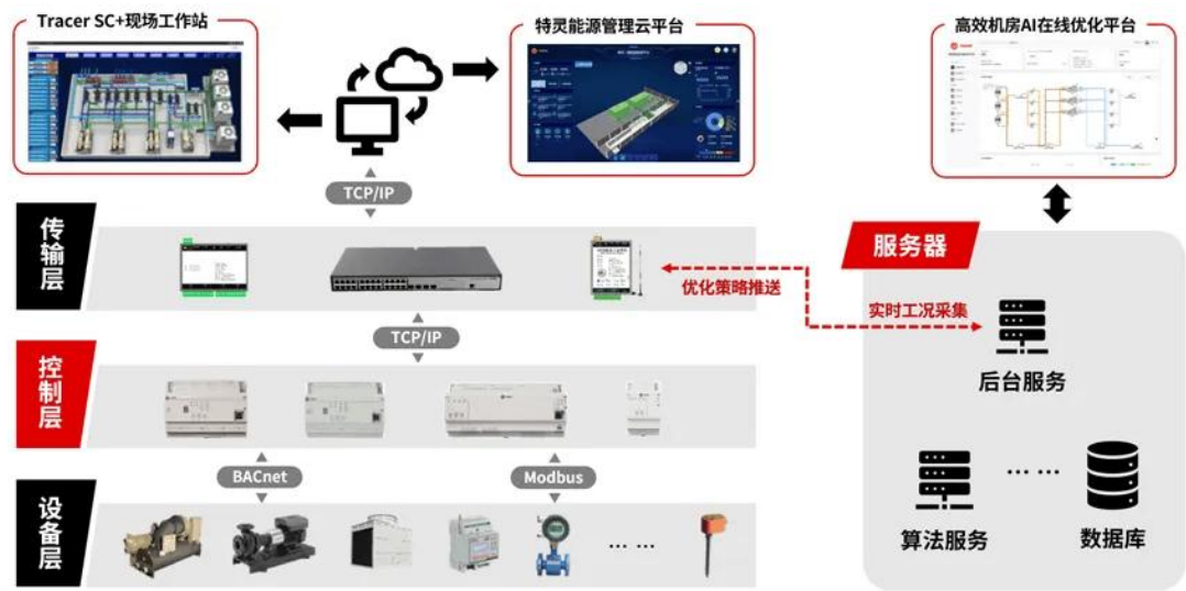
图 1-2 高效机房 AI 在线优化平台系统架构图
